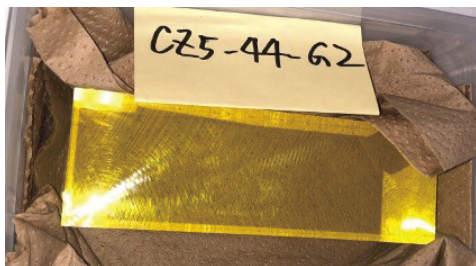
Fig. 1. The GAGG(Ce) crystal ( 40 \times 40 \times 120 \text{ mm}^3 ).
